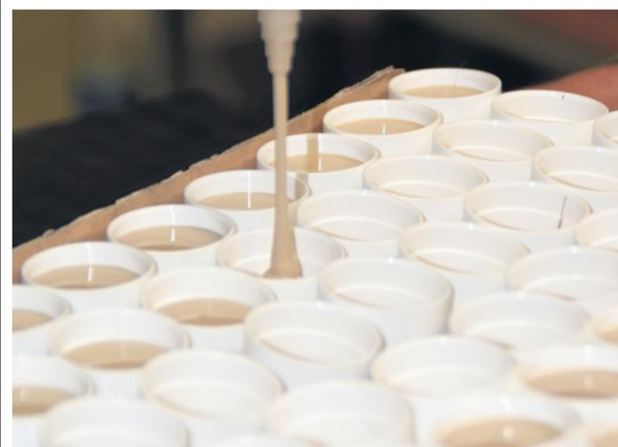
Bislang werden die Borsten eines Pinsels mit formaldehydhaltigem Kleber fixiert – wie hier bei Rundpinseln.
